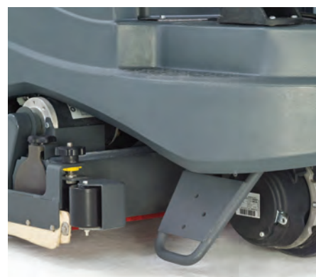
Både skurdäcket och sugskrapan skyddas av stora stötfångare.
